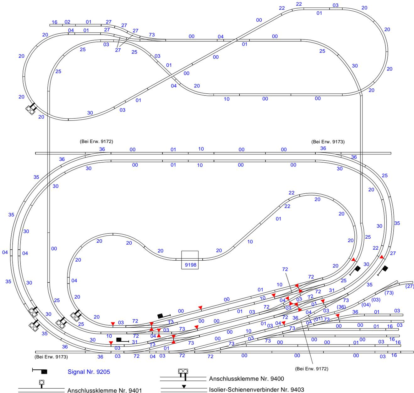
Die Weichen des Überholgleises/Abstellgleises können durch Entfernen der äusseren Drahtbrücken in zweiseitig wirkende Stop-Weichen verwandelt werden. Dadurch können Loks nach Umstellen der Weichen stromlos abgestellt werden.
