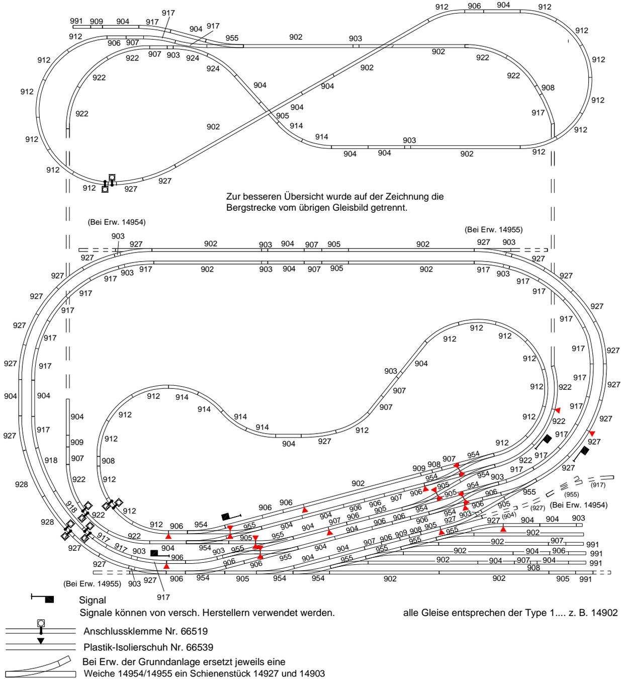
Die Weichen des Überholgleises/Abstellgleises können durch Entfernen der äußeren Drahtbrücken in zweiseitig wirkende Stop-Weichen verwandelt werden. Dadurch können Loks nach Umstellen der Weichen stromlos abgestellt werden.
