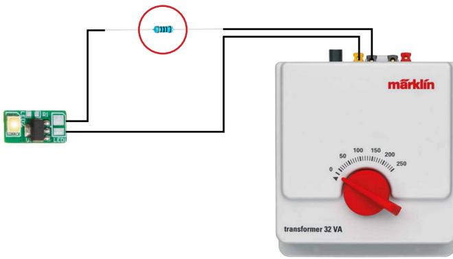
**D Anleitung zum Anschluss des Widerstands bei Verwendung eines Transformators mit Wechselstrom-Ausgang (max. 16 V).**
